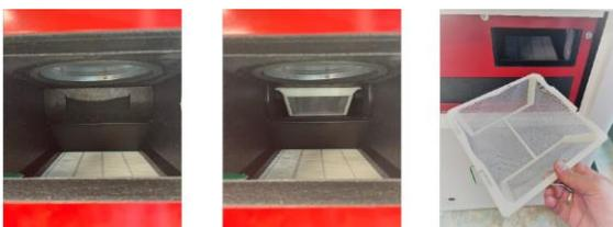
3. Grobfilter mit warmen Wasser reinigen und trocknen.
