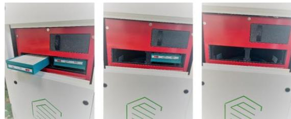
3. Filterkammer von Hand oder mit Staubsauger reinigen.
